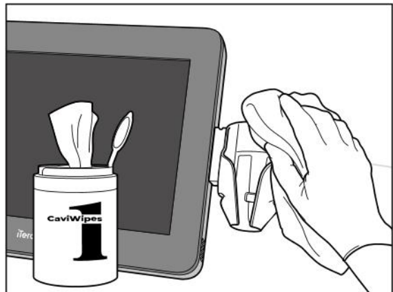
Figur 208: Torka av iTero Element 2 Plus -hållaren med mobil konfiguration
